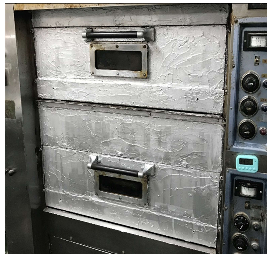
断熱塗料塗装後
