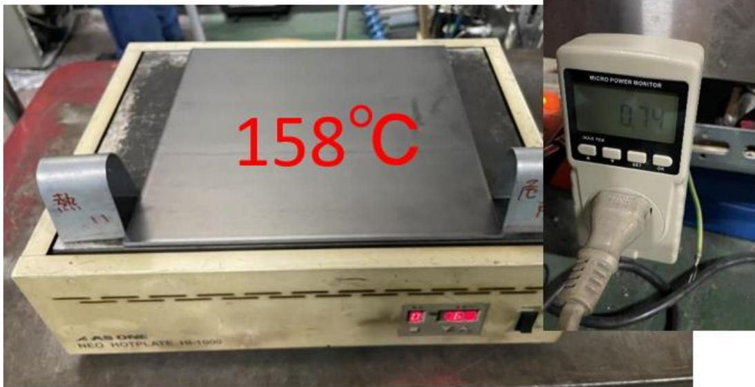
測定結果：0.74kwh/2時間 0.37kwh
