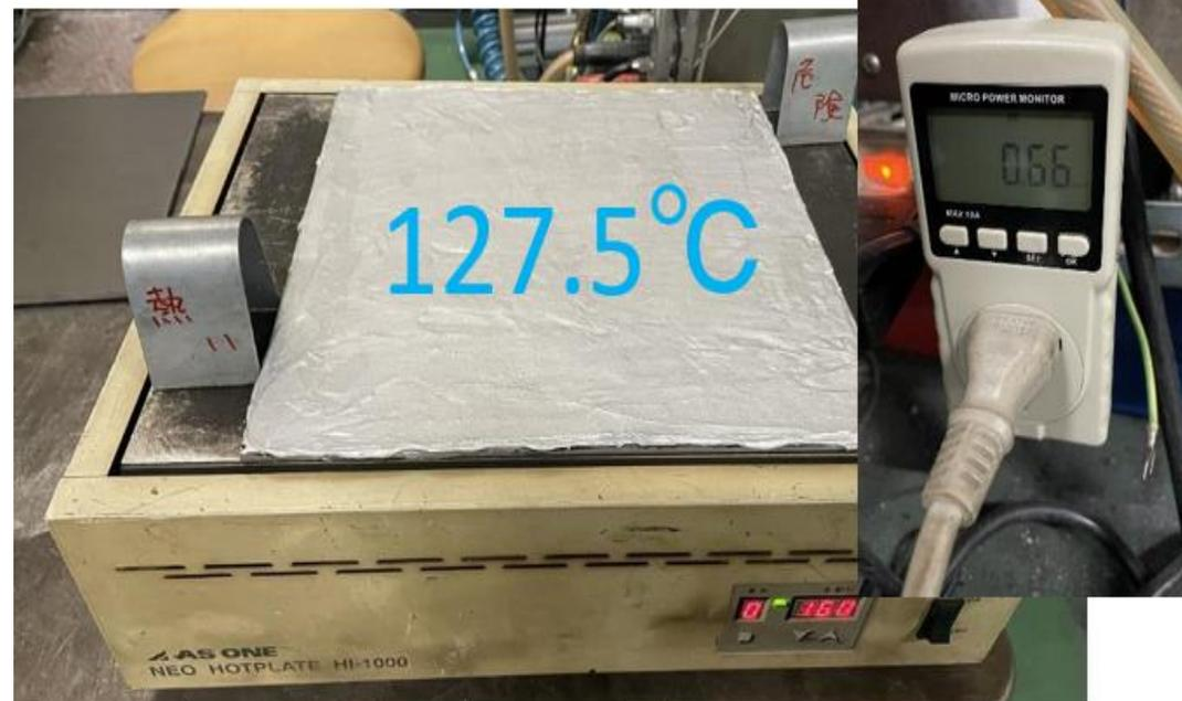
測定結果：0.66kwh/2時間 0.33kwh
